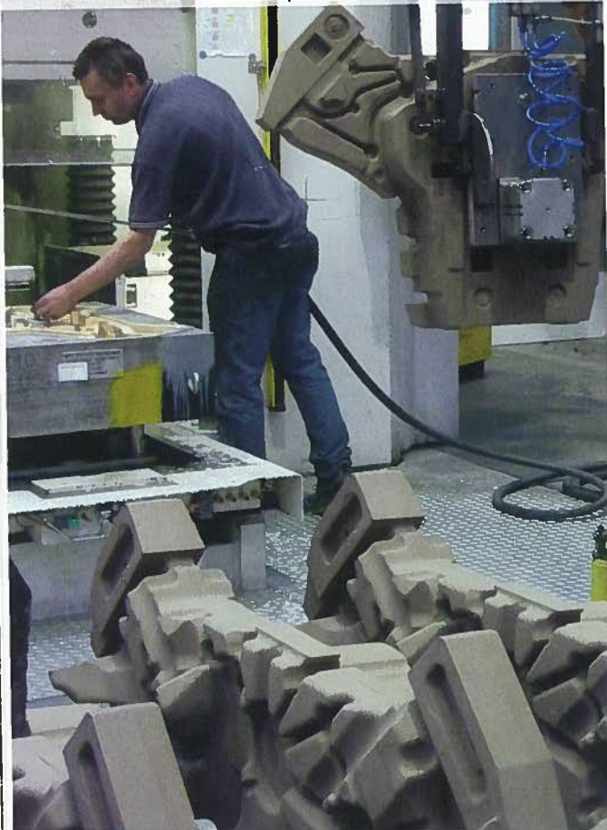
Bild 1: Die Kernfertigung an dem neuen Lampe-Kernschießautomaten. Fotos: Luitpoldhütte
